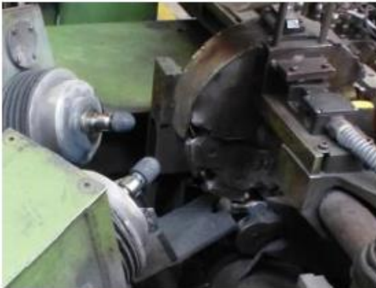
Fig.: Unidades de alimentação com ferramentas de rebarbação
