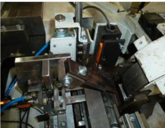
Fig.: Transferência para o disco de fixação
